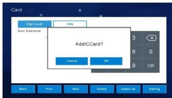
4. پس از کلیک بر روی "تایید"، پنل ورودی (شاسی زنگ) وارد حالت افزودن کارت می شود، نشانگر وضعیت به آرامی چشمک می زند.
